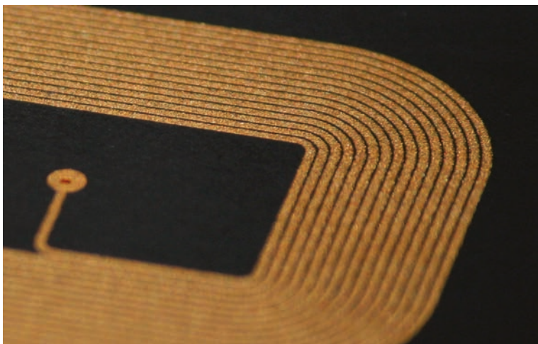
Fig. 3 - La tecnologia 3D-MID permette di disporre di una estrema libertà nella progettazione e produzione di antenne
