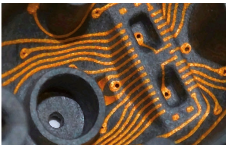
Fig. 1 - 3D-MID possono essere prodotti con tracce fino a una miniaturizzazione di 80 µm
